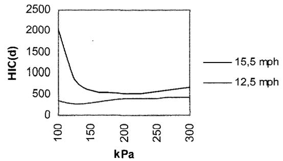
Figure 19. HIC(d) vs bag pressure
