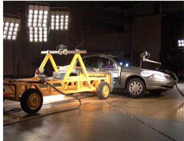
**FIGURE 7 WorldSID barrier test.**
