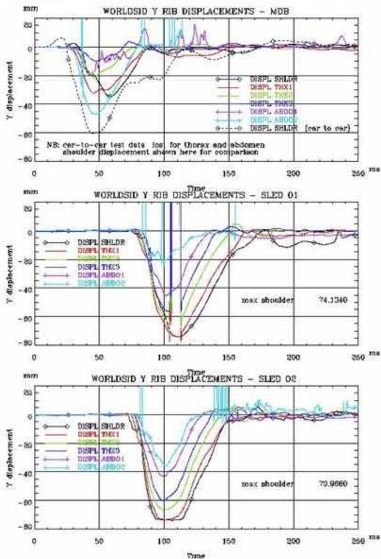
FIGURE B 7 Rib displacements (CFC 600)
